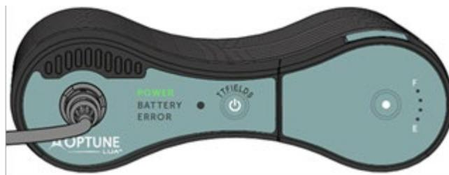
REMARQUE : si une batterie chargée est installée (et qu'aucun bloc d'alimentation n'est connecté), le voyant « BATTERY » (BATTERIE) vert s'allume. Si le dispositif est connecté au bloc d'alimentation, il sera alimenté par le bloc d'alimentation et le voyant « BATTERY » (BATTERIE) s'éteindra.
