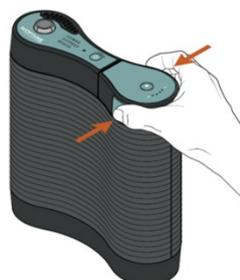
Pour retirer la batterie de son emplacement, appuyez sur les deux boutons bleus situés sur les côtés de la batterie et soulevez-la.
